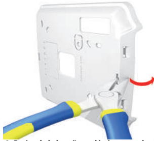
Figura 2: Retiro de la lengüeta plástica para el cableado en superficie
